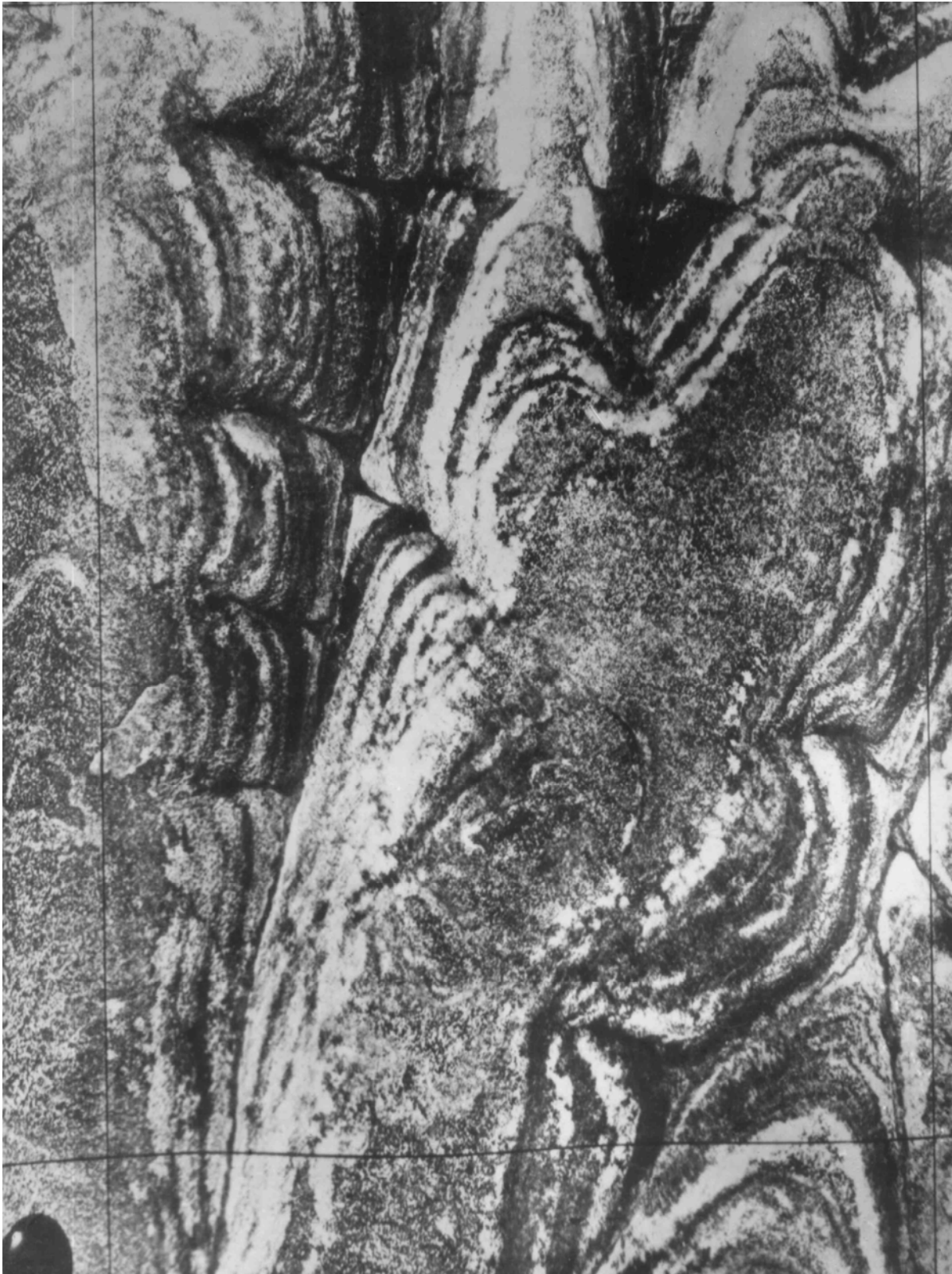
Рисунок 15.3. Конфігурація геологічних границь (фотомаркувальних горизонтів) при горизонтальному заляганні шарів гірських порід
